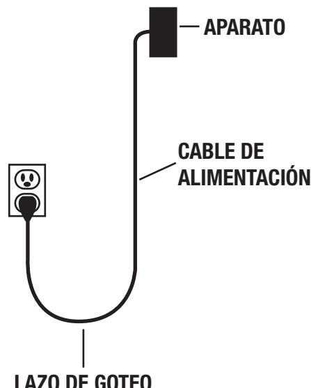
Monte el transformador en posición horizontal sobre una superficie sólida fuera del alcance de niños pequeños y al menos a 1 metro (39 pulgadas) sobre el nivel del piso.
